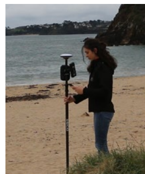
Mesure de la hauteur de sable sur la plage grâce au GPS Centipède. Photo : Pauline Richard
